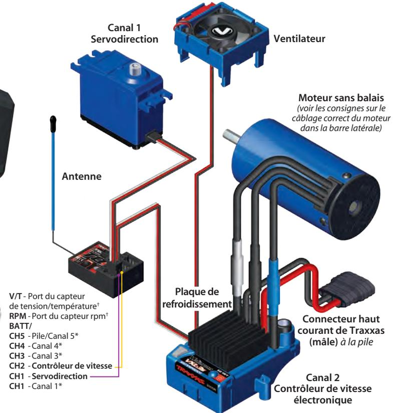
\*Non utilisé †Ports de capteur accessoire à utiliser avec les capteurs standard de télémétrie pour la tension/température et RPM (voir plus de renseignements sur Traxxas.com et dans les matériels fournis)
